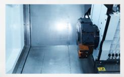
车铣复合机床将数控车床车铣多边机床完美的结合一体,兼 具数控车削与多边成形切屑功能,可一次性完成车外圆,打 孔,切断及车多边等多项工艺。(产品同心度高,一机多用)。 车铣复合机床采用床身床脚连体翻砂工艺,采用滚柱进口线 轨及丝杠,所以抗震性好,切削力度強。
